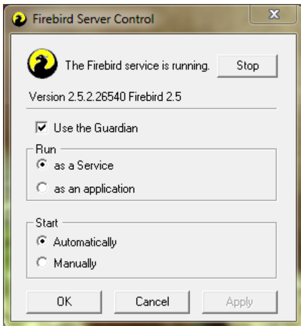
Abb.: Firebird - Systemsteuerungsapplet
